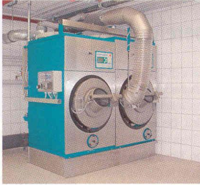
Die Waschsleudermaschinen Variofex 17 und Variofex 25 mit Pneuma-Load-Beladesystem.
