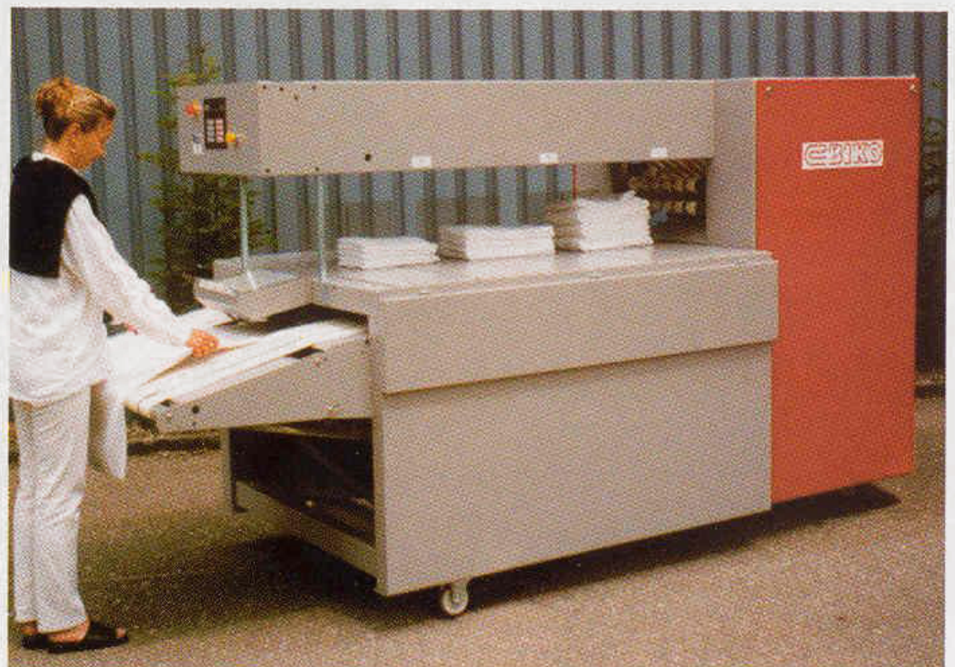
Die Falanlage Maria der Biko AG, eine Trockenwäschefaltmaschine, eignet sich zum Sortieren, Legen und Stapeln von Flach- und Formteilen.
